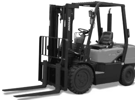
Wózki z napędem Diesla D20G / D25G / D30G 2000 kg 2500 kg 3000 kg
